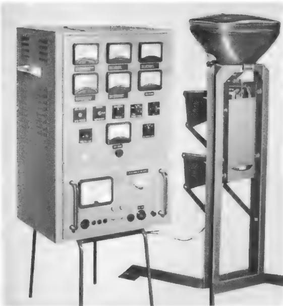
Bild 4. Bildröhren-Prüfgerät für größere Werkstätten (Modell STT 500 der NEV)
