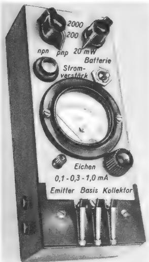
Bild 5. Ansicht des Transistor-Prüfgeräts
