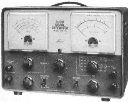
**LEADER LAG-65** NF-Meßgenerator mit eingebautem Frequenzmesser 10 Hz bis 100 kHz, Klirrfaktor 0,5 %, Frequenz- und Ausgangsspannung werden an zwei Instrumenten abgelesen. **DM 429.-**
