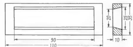
Bild 23. Holzrahmen zur Skala
