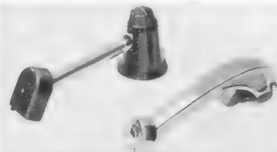
Bild 3. Zwei Vorläufer unserer heutigen Leichttonabnehmer. Links: Ebner-Tonarm aus dem Jahre 1934, rechts Perpetuum-Tonarm aus dem gleichen Jahr, beide mit Magnetsystem und einem Auflagegewicht von rund 100 g
