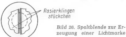
Bild 26. Spaltblende zur Erzeugung einer Lichtmarke
