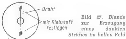
Bild 27. Blende zur Erzeugung eines dunklen Striches im hellen Feld
